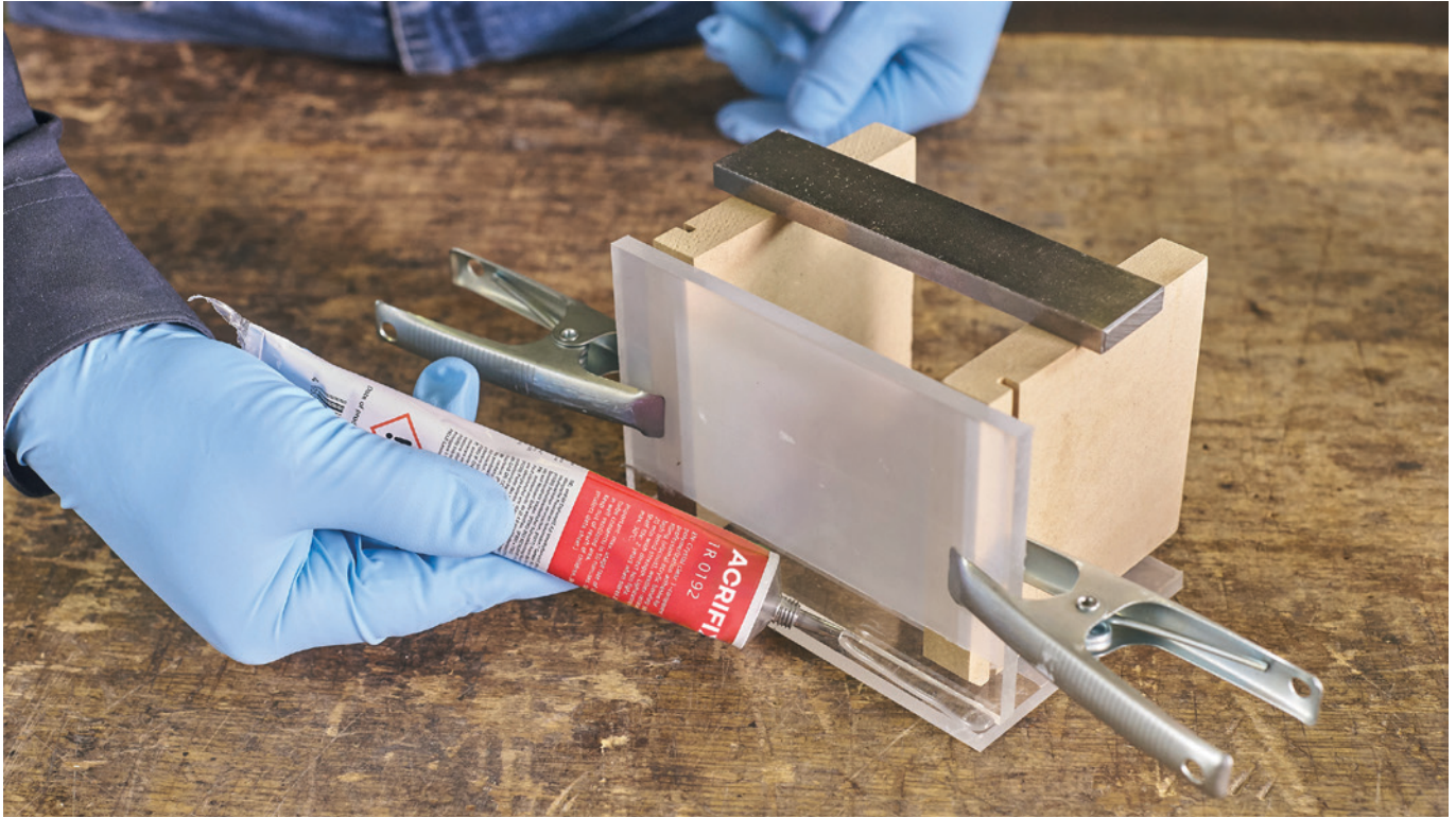
Bond PLEXIGLAS® sheets in a vertical position using gap-filling ACRIFIX® 1R 0192
